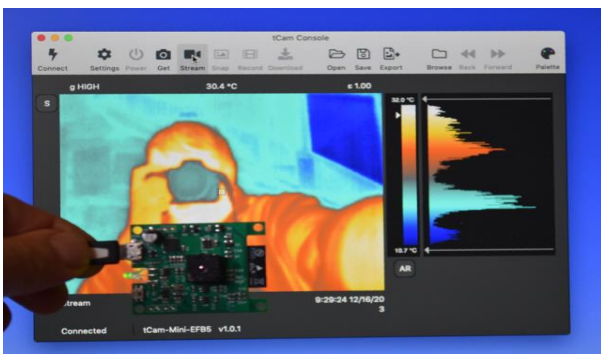
Зураг 7. Температурын ялгаатай байгаа байдлыг дулаан мэдрэгч камераар харж, турисан байдал
