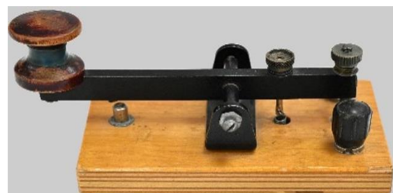
Зураг. 3. Уламжлалт Морзын код үүсгэгч телеграфын механик түлхүүр
