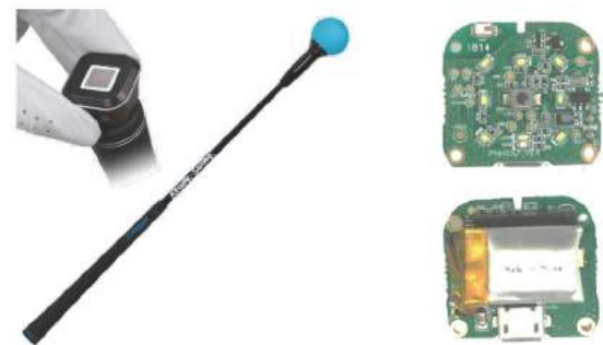
Зураг. 8. Төхөөрөмжийн PCB түүнийг цохиурын ишинд бэхэлсэн байдал
