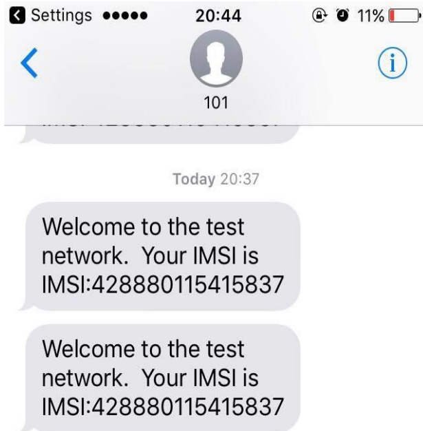
Зураг 9. Гар утас сүлжээнд холбогдсон ба сүлжээ нь тухайн холболтонд IMSI дугаарыг илгээсэн байдал
