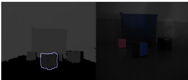
Зураг 10. Харанхуй байх үед. Зүүн: Зайн мэдээллээр объектыг илрүүлсэн үр дүн. Баруун: Дижитал камераар авсан зураг
