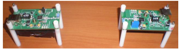
Зураг 3. Өөд өдөөсөө харсан чип антентай Зигби модул
