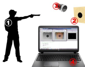
Зураг 1. Буудлагын бэлтгэлийн e-систем: 1-лазер гэрлэн сумтай бэлтгэлийн буу, 2-бай, 3-байны дүрс унших камер, 4-дүрс боловсруулах програм хангамж
